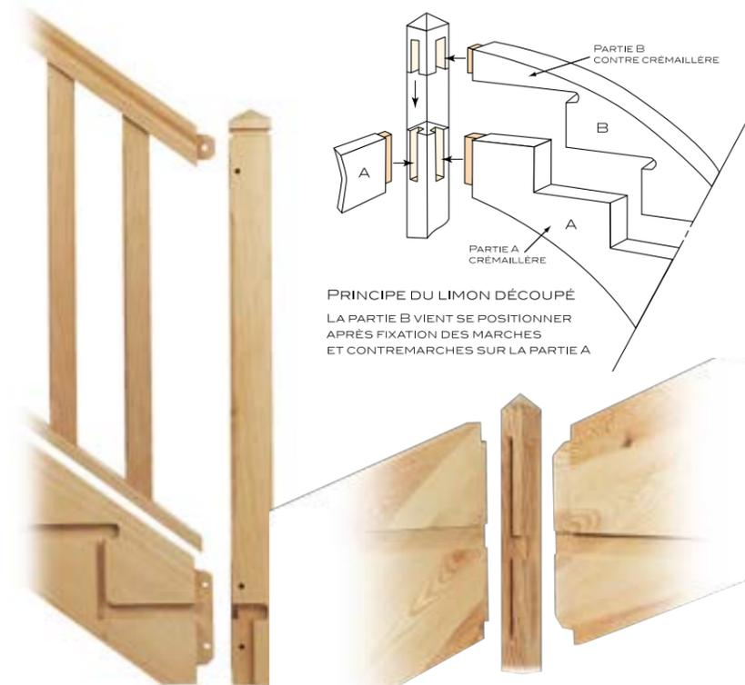
LES MAINS COURANTES ET LIMONS SONT ASSEMBLÉS AUX POTEAUX PAR TENONS, MORTAISES ET CHEVILLES DE BOIS LA POSE EST AINSI SIMPLIFIÉE.
