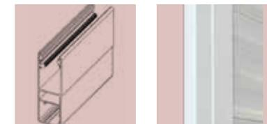
Fixe, sans talon, en alu extrudé avec joint latéral en caoutchouc anti-bruit et joint brosse supplémentaire pour une meilleure étanchéité (section 110/35 mm).
