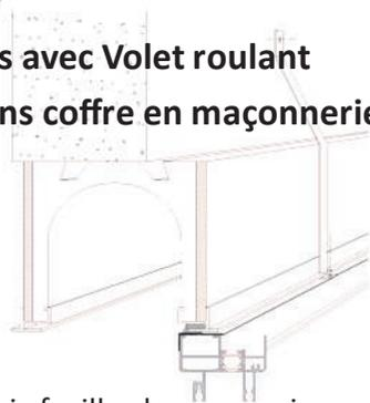
Prévoir feuillard pour reprise sur Gros Oeuvre au dessus du coffre Volet roulant en maçonnerie
