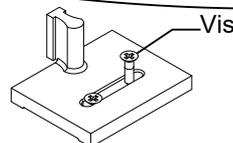
OPTION AMORTISSEUR : BLOQUEZ LES DOIGTS A L'AIDE D'UNE SECONDE VIS
