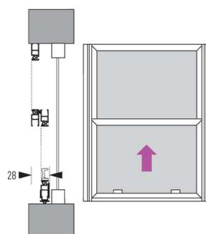
Dans le cas où l'espace de pose est très réduit, inférieur à 50 mm (mini 28 mm en partie haute) : vous devez prévoir d'incorporer les poignées dans l'épaisseur des profils et/ou d'utiliser un profil de base de 30 x 15.
