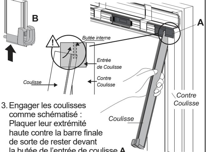
3. Engager les coulisses comme schématisé : Plaquer leur extrémité haute contre la barre finale de sorte de rester devant la butée de l'entrée de coulisse A.
