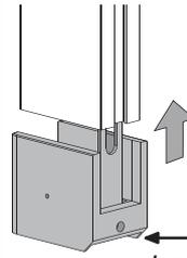
Si besoin, tailler au cutter un des 2 rails sous de l'embase pour rattraper l'inclinaison de l'appui
