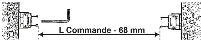
2. Monter le châssis supérieur
