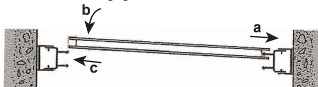
3. Glisser le châssis au maximum vers le Haut et monter un clip sur chaque rail pour le bloquer en position haute.
