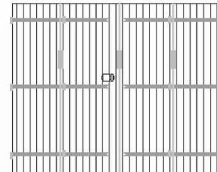
Porte de garage à 4 vantaux à pentures et contre-pentures (PC3) ouverture intérieure ou extérieure en 28 mm présentée avec l'option pentures queue de carpe.
