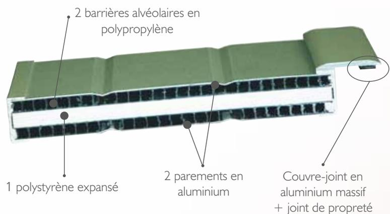
Nos volets en aluminium gamme Harmonie sont fabriqués à partir de panneaux de 28 mm constitués de :
