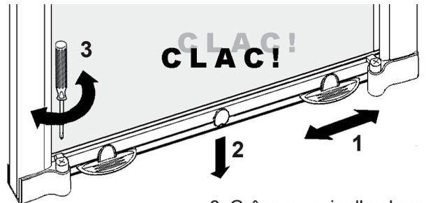
3. Grâce aux vis d'embase, régler la hauteur des becs d'accroche de sorte que :
